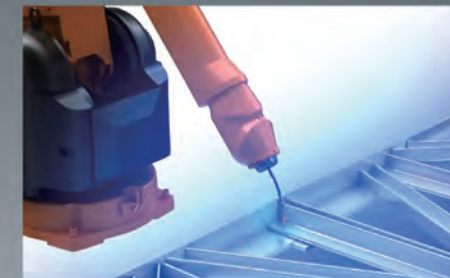
机器人焊接 Robotic Welding
